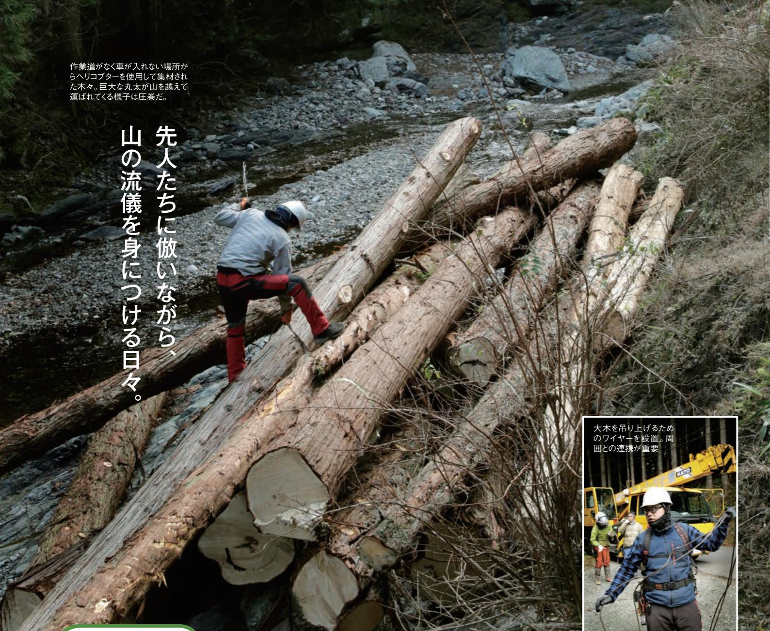
作業道がなく車が入れない場所からヘリコプターを使用して集材された木々。巨大な丸太が山を越えて運ばれてくる様子は圧巻だ。
